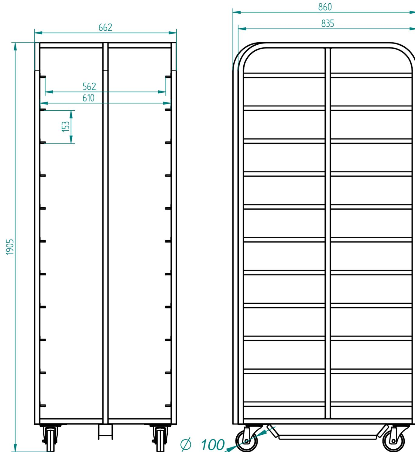
Тележка-шпилька ТШГ-11-8-6 является вспомогательным оборудованием для предприятий общественного питания и для установки и транспортировки до 11-ти противней размером 600x800 мм. Расстояние между уровнями 153 мм. Имеет поворотные колеса. Допускается использовать в ротационном пекарском шкафу РПШ-18 при приготовлении блюд, ввиду использования в тележке-шпильке термостойких колес.
