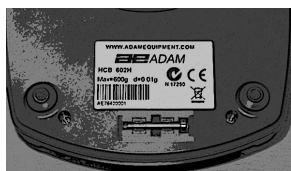
Место хранения ручки для опускания встроенной юстировочной гири
